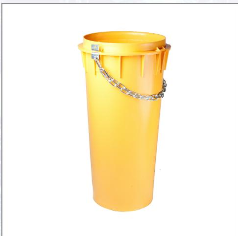
Die Rohre sind konisch und daher platzsparend bei Transport und Lagerung. Extra starke Ketten mit Karabinern verbinden die einzelnen Elemente miteinander. Das erste Schuttrrohr muss fest gesichert werden! Eine Befestigung/Verankerung der Bauschuttrutsche an jedem zehnten Rohr am Gebäude bzw. Gerüst ist unbedingt erforderlich! Das Gesamtgewicht der Bauschuttrutsche darf 250 kg nicht überschreiten. Das untere Rutschende leicht krümmen, um die Fallgeschwindigkeit des Schutts zu verlangsamen.
