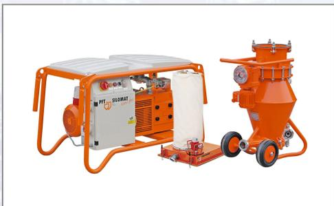
Funktionsbeschreibung: Die PFT SILOMAT TRANS PLUS fördert vollautomatisch und staubfrei Trockenmörtel zur Mischpumpe oder zum Durchlaufmischer. Die PFT SILOMAT TRANS PLUS vereint Design und Leistungsfähigkeit. Die Handhabung und der Transport der SILOMAT-Anlage wurden durch viele Helfer vereinfacht, wie zB die integrierten Krantransportösen und ausklappbaren Tragegriffe. Mit ein paar Handgriffen passt das PFT SILOMAT Fördergefäß an jeden Container/Silo. Die PFT
