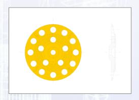
Die Isolierteller können wegen ihrer flachen Unterkopfgeometrie überall dort eingesetzt werden, wo der Einzug des Tellers in den Dämmstoff nur schwer möglich ist. Durch Kombination mit entsprechenden Schrauben oder Dübeln wird eine sichere Verankerung im Untergrund hergestellt.
