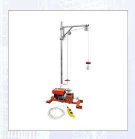
Die Bauwinden IORI bieten Höchstleistungen am Bau bei einfacher und sicherer Handhabung. Für das Fixieren der Bauwinde am Boden können Rohre mit der Dimension 48 x 2,9 mm durch den Rahmen geschoben werden, die dann mit Gewichten beschwert werden. Technische Daten: - Motor: 0,85 kW, 230 V, 50 Hz, - Tragkraft: max. 200 kg, - Seillänge: 50x2 m, - Seildurchmesser: 5 mm, - Hubgeschwindigkeit: 25 m/min, - Eigengewicht: 77 kg, - mit Laschen für Schwenkbügel.
