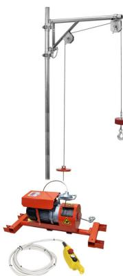
Die Bauwinden IORI bieten Höchstleistungen am Bau bei einfacher und sicherer Handhabung. Für das Fixieren der Bauwinde am Boden können Rohre mit der Dimension 48 x 2,9 mm durch den Rahmen geschoben werden, die dann mit Gewichten beschwert werden. Technische Daten: - Motor: 0,85 kW, 230 V, 50 Hz, - Tragkraft: max. 200 kg, - Seillänge: 50x2 m, - Seildurchmesser: 5 mm, - Hubgeschwindigkeit: 25 m/min, - Eigengewicht: 77 kg, - mit Laschen für Schwenkbügel.
