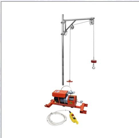
Die Bauwinden IORI bieten Höchstleistungen am Bau bei einfacher und sicherer Handhabung. Für das Fixieren der Bauwinde am Boden können Rohre mit der Dimension 48 x 2,9 mm durch den Rahmen geschoben werden, die dann mit Gewichten beschwert werden. Technische Daten: - Motor: 0,75 kW, 230 V, 50 Hz, - Tragkraft: max. 200 kg, - Seillänge: 25x2 m, - Seildurchmesser: 5 mm, - Hubgeschwindigkeit: 25 m/min, - Eigengewicht: 63 kg, - mit Laschen für Schwenkbügel.
