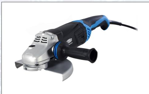
Mit dem AGE230 erhalten Sie einen handlichen und schlank konzipierten 230 mm Winkelschleifer mit zusätzlicher Vibrationsdämpfung und Stielhandgriff inkl. Softeinlage für sicheren Halt, Softstart und werkzeuglos verstellbarer Schutzhülle. Der Winkelschleifer verfügt über eine Wiederanlaufsperrre bei Stromausfall, Einschaltsperrre und Spindelarretierung. Technische Daten: - Nennleistung: 2100 W, - max. Scheibendurchmesser: 230 mm, - Leerlaufdrehzahl:
