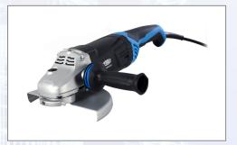
Mit dem AGE230 erhalten Sie einen handlichen und schlank konzipierten 230 mm Winkelschleifer mit zusätzlicher Vibrationsdämpfung und Stielhandgriff inkl. Softeinlage für sicheren Halt, Softstart und werkzeuglos verstellbarer Schutzhaube. Der Winkelschleifer verfügt über eine Wiederanlaufsperre bei Stromausfall, Einschaltsperre und Spindelarretierung. Technische Daten: - Nennleistung: 2100 W, - max. Scheibendurchmesser: 230 mm, - Leerlaufdrehzahl:
