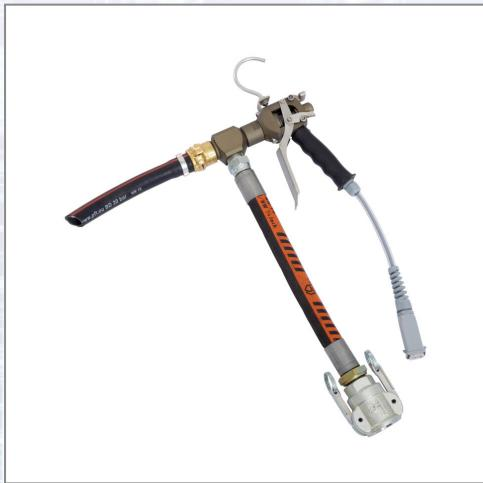
Der PFT ZARGOMAT PRO ist ein professionelles Einhand-Spritzgerät zum Verguss von Zargen, Auftragen von Klebemörtel auf Platten für WDV- Systeme, Vergießen der Sichtfugen, Injizieren von Verfüllmörtel etc. Ausgestattet mit: - Klebeschlauch d= 19 mm, 290 mm für den Materialauftrag, - Mörtelschlauch d= 25 mm - 1,5 m, - Kupplung d= 25 mm M-Teil zum Anschluss am Materialschlauch, - Drehgelenk an der Mörtelkupplung.
