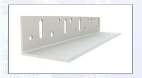
In Kombination mit dem Sockel-/Anschlussprofil Z4210000014 kann der Wandteil zu einem Sockelprofil für Dämmstoffstärken 100-125 mm variabel ausgebildet werden. Die Montage kann ohne Sockelprofilverbinder durch versetzten Einsatz beider Profile erfolgen.
