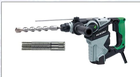
Kombihammer zum Hammerbohren (Beton, Stein, Ziegel), Bohren (Holz, Metall) und Meißeln (leichte Stemmarbeiten) mit staubgeschützter SDS-Plus-Werkzeugaufnahme. Ausgestattet mit einem Drehstopp für leichte Meißelarbeiten in Ziegel (in Beton nur bedingt einsetzbar). Die Steuerelektronik sorgt für eine stufenlose Dreh- und Schlagzahlvorwahl über Schalter. Der Kombihammer ist außerdem mit einem Soft-touch Handgriff für
