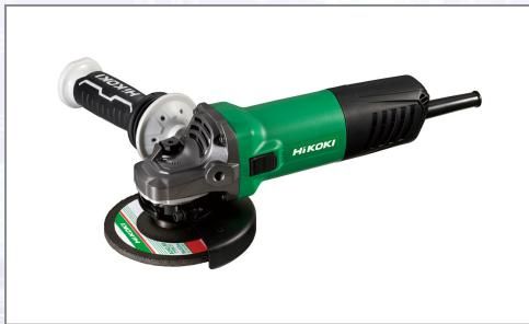
Arbeiten in Ecken und an engen Stellen durch den besonders flachen Getriebekopf. Die Schnellverstellung der Schutzhülle ist werkzeuglos möglich. Ausgestattet mit einer Spindelarretierung für schnellen und sicheren Scheibenwechsel, Anlaufstrombegrenzung, Wiederanlaufschutz sowie sicheren Auslaufablage. Technische Daten: - Leerlaufdrehzahl: 11000 /min, - Leistungsaufnahme: 1200 W, - Scheibendurchmesser: 125 mm, - Gewicht (nur Maschine): 2,4 kg. Im Lieferumfang
