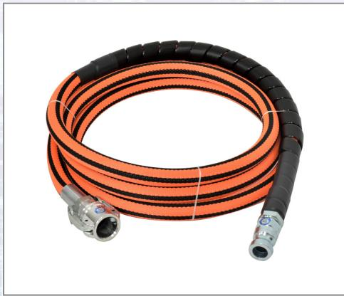
Ultraleichter Mörtelschlauch für Gipsputz und Kalk-Zement-Putz (Korngröße = 3 mm), hydraulisch eingebunden, Mörtelkupplung einfach tauschbar, PUR-Seile (1 mm) - hohe Abriebfestigkeit nach DIN 14811, Schlauch-Knickschutz am V-Teil. Technische Daten: - Innendurchmesser: 25 mm, - Betriebsdruck: max. 40 bar, - Berst-/Platzdruck: 125 bar, - Biegeradius: 200 mm, - Gewicht: 2,9 kg.
