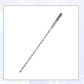
Hammerbohrer mit Spitzenleistungen in (armiertem) Beton, Mauerwerk, Natur- und Kunststein. Vollhartmetallkopf - Extrem hohe Lebensdauer bei optimaler Bohrleistung. Kernverstärkte Bohrerstruktur - Für eine optimale Schlagenergieübertragung und Bruchstabilität. IRON BLAST TECHNOLOGY - Durch Beschuss der Oberfläche mit Stahlkugeln werden Spannungen im Bohrkopf reduziert und die Festigkeit entlang der Nut erhöht.
