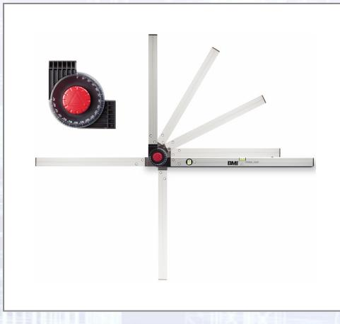
Robuster, zusammenklappbarer Bauwinkel 100 x 150 cm, zum stufenlosen Übertragen und Abnehmen von Winkeln von 0 ° bis 270 °. In 15 °-Schritten können die Winkel fest arretiert werden. Durch die eingebauten Libellen als Wasserwaage verwendbar. Leicht zu transportieren. Robuste Gelenkverbindungen aus hochwertigem Kunststoff.
