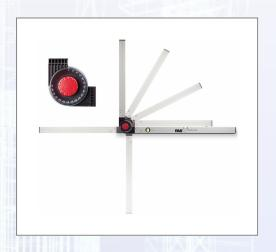
Robuster, zusammenklappbarer Bauwinkel 100 x 150 cm, zum stufenlosen Übertragen und Abnehmen von Winkeln von 0 ° bis 270 °. In 15 °-Schritten können die Winkel fest arretiert werden. Durch die eingebauten Libellen als Wasserwaage verwendbar. Leicht zu transportieren. Robuste Gelenkverbindungen aus hochwertigem Kunststoff.
