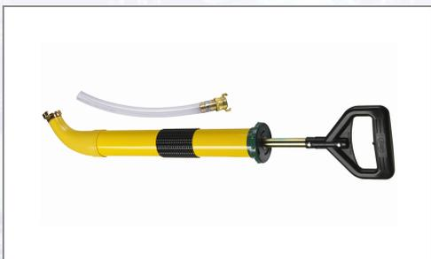
Die leichte und handliche Pumpe verfügt über eine patentierte Kolbendichtung, so dass selbst Überkopfarbeiten möglich ist. Die Pumpe wird mit der Öffnung in vorgemischtes Material eingebracht, mittels Ziehen des Kolbens entsteht ein Vakuum, das das Material in die Pumpenkammer zieht. Nun kann der Mörtel in Fugen, Zargen oder Hohlräume per Kolbendruck eingebracht werden. Keine Stromversorgung erforderlich. Einfach zu handhaben und zu reinigen. Füllmenge: 0,9 kg. Mit
