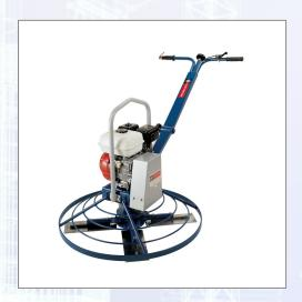
Flügelglätter LEVEL 100 mit 4 Feinbearbeitungsflügel und Schutzbügel. Zusammenlegbarer Führungsarm und Einstellung der Flügelneigung mittels mechanischen Systems. Fliehkraftkupplung, verzinkte Schutzgitter, Totmannschaltung und Schnellverstellung der Führungsdeichsel. Ausführung mit 4-Takt-Benzinmotor oder mit Elektromotor. Technische Daten: -Durchmesser: 900 mm, - HONDA Benzinmotor GX 160: Leistung 4,1 kW, - Gewicht: 70 kg.
