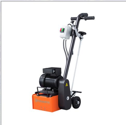
Für kleine bis mittlere Einsatzflächen zum Aufräumen von Beton, Rillieren von Betonflächen, Abfräsen von Beschichtungen und Markierungen. Einfacher seitlicher Austausch der Frästrommel. Stufenlose und millimetergenaue Einstellung der Arbeitshöhe. Mit Anschluss für Staubabsaugung. Technische Daten: - Elektromotor: 230 V/16 A/1,8 kW, - Arbeitsbreite: 215 mm, - Sauganschluss d= 51 mm, - Gewicht: 63 kg. Im Lieferumfang enthalten: komplette Frästrommel mit 84 Stück Schlaglamellen bestückt.
