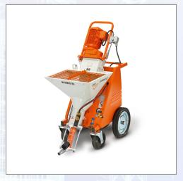
Die kompakte Mischpumpe mit 230 V Wechselstrom- und/oder 400 V Drehstrom-Antrieb wurde speziell entwickelt zum Pumpen, Verspritzen und Auftragen von maschinengängigen Trockenmörteln, pastösen Materialien und vielem mehr bis 7 mm Korngröße. Die Pumpenleistung kann je nach Anforderung durch einen schnellen Pumpenwechsel angepasst werden. Die pneumatische Befüllung ist über eine optionale Einblashaube gewährleistet. In drei Baugruppen zerlegbar. Grundausstattung:
