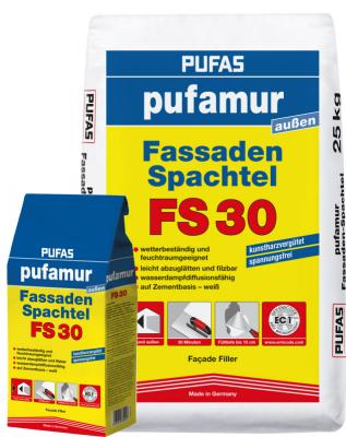
Zum Ausbessern, Nivellieren und Beschichten von allen mineralischen Untergründen wie Fassaden, Wand- und Deckenflächen. Für den Außen- und Innenbereich. Witterungsbeständig und feuchtraumgeeignet, auf Zementbasis, kunstharzvergütet, leicht abzuglätteln, filzbar, ca. 30 Minuten verarbeitungsfähig, weiß, chromatarm gemäß EU-Verordnung 1907/2006, Anhang XVII (47).
