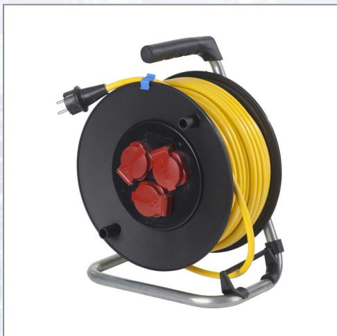
Sicherheits-Kabeltrommel aus robustem, hochbruchfestem Spezialkunststoff mit stabilem, stoßdämpfendem, verzinktem Einfach-Fußgestell, Feststellbremse, ergonomisch geformtem Haltegriff, patentierter Leitungsführung, eingebautem Thermoschutzschalter und 3 Schutzkontaktsteckdosen (230 V, 16 A, max. 3500 W) mit Sicherheitsklappdeckeln und Hammerzeichen. IP44: fremdkörper- und spritzwassergeschützt. Geprüft nach EN 61242, DIN VDE 0620-2-1, ÖVE E8241-55.
