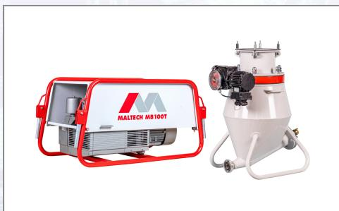
Die MALTECH Förderanlagen für Freifallsilos fördern vollautomatisch und staubfrei Trockenmörtel zur Mischpumpe oder zum Durchlaufmischer. Mit Phasenüberwachung – dadurch Vermeidung von falscher Drehrichtung. Besserer Korrosionsschutz durch verzinkte und pulverbeschichtete Ausführung. Effiziente Förderung durch Einsatz der ALU-Förderdüse. Stopfervermeidung durch Drucküberwachung.
