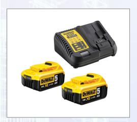
Set bestehend aus: 2 x Akkus DCB184 und 1 x System-Schnellladegerät DCB115. Passend für alle Akku-Maschinen (in NT-Version) aus dem AkkuPlus-Programm sowie für 18,0 Volt-Maschinen in N-Version von DEWALT®. Technische Daten Akku DCB184: Akku-Leistung und Kapazität: 18 Volt Li-Ion/5,0 Ah, Abmessungen: 11,5x7,5x7 cm, Gewicht: 0,6 kg. Technische Daten System-Ladegerät DCB115: Für Akku-Typ (Volt): 10,8/14,4/18,0 XR Schiebe-Akkus, Abmessungen: 15x11,5x8 cm.
