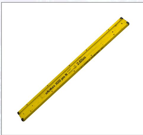
Formstabiler Vollwandträger mit dreischichtigem Steg und einer Endverstärkung aus PUR. Schalungsträger gemäß der europäischen Norm EN 13377. Oberfläche: gelb lasiert. Zulässiges Biegemoment:  $M = 5,0 \text{ kNm}$ , zulässige Querbelastung:  $Q = 11,0 \text{ kN}$ , Steifigkeit:  $450 \text{ kNm}^2$ , Träger-Gewicht:  $4,4 \text{ kg/m}$ .
