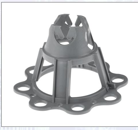
Abstandhalter aus Kunststoff mit großer Aufstellfläche zur Verwendung auf weichem Untergrund. Für Eisen 8-16 mm. Material: - Polyolefin PO (High-Density Polyethylen HD-PE + Polypropylen PP), - frei von PVC, FCKW und HFKW, - ohne besonders besorgniserregende Stoffe gemäß Kandidatenliste der ECHA (REACH-Verordnung).
