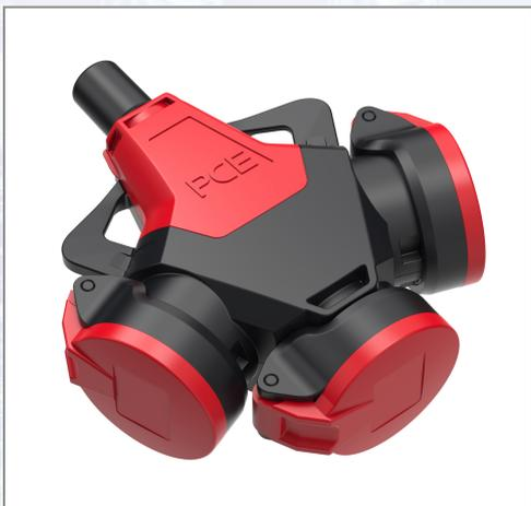
3-Wegekupplung (Vollgummi) mit Klappdeckel. Farbe Gehäuse/Anschlussabdeckung: schwarz/rot. Kontaktträger: TPE. Fertig verdrahtet auf 5-polige Anschlussklemme (PH1). Schutzleitersystem: österr./deutsches System (Typ F - mit Schutzleiterbügel). Kontakte: vernickelt. Innenliegende Zugentlastung mit Knickschutztülle. Für erschwerte Bedingungen geeignet, 16 A 250 V, 3p (2P+E). IP 54 staub- und spritzwassergeschützt.
