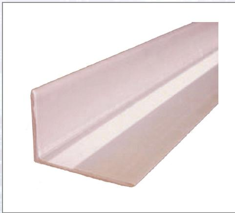
Der feuchtigkeitsbeständige Estrich-Abstellwinkel mit Kaschierung schließt eine Lücke in Bodenkonstruktionen. Speziell im Estrich- und Fußbodenbau sind seine Einsatzbereiche vielfältig: - im Türbereich, - über Heizrohren zur Dehnfugenausbildung, - zur Längsabschalung von Treppenpodesten und Balkonen. Bei einer notwendigen Schall-Längsleitungs-Unterbrechung wird der Winkel mit handelsüblichen Schwellenklebern oder mit selbstklebenden Randstreifen abgeklebt.
