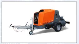
Der EstrichBoy DC 260 STAGE V ist eine zuverlässige, robuste sowie effiziente Estrichpumpe mit hoher Förderleistung von erdfeuchten Estrichen wie Zementestrich, Calciumsulfatestrich (Anhydrit), Magnesiaestrich und Rüttelboden. Der umweltfreundliche, effiziente und spritsparende DEUTZ-Dieselmotor ist mit einem extra großen 70-Liter-Tank ausgestattet, welcher alle Anforderungen des gültigen
