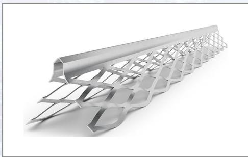
Das scharfkantige Eckprofil besteht aus gestrecktem und verzinktem Stahl und dient im Innenputz als Kantenschutz für mechanisch starkbeanspruchte Bereiche wie z.B. Mauerkanten und Fensterlaibungen und sorgt gleichzeitig für exakte Kanten. Verstärkte Ausführung hergestellt aus 0,6 mm starken, 1a sendzimir verzinkten Stahlblechen oder Spaltbänder mit einer zweiseitigen Zinkauflage von mindestens 275 g/m<sup>2</sup> gemäß BS EN 10346:2009-DX51+Z275 und EN 13658-1:2005. Technische
