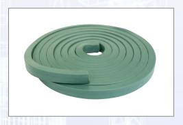
Hydrophiles, quellfähiges Fugenband aus hochwertigem Natriumbentonit und Butylkautschuk für die vorbeugende Abdichtung von Arbeitsfugen und als Systemkomponente für Bentonitmatten. BENTOSWELL ist nach 3 Nass- und Trockenzyklen formstabil (MFPA zertifiziert). Dennoch kommt es zu einer gewissen Auswaschung. Der Vorteil dieses Phänomens ist, dass Hohlräume/Risse im Beton aufgefüllt werden. BENTOSWELL hat eine gute Beständigkeit gegen eine große Anzahl von Chemikalien. Material: Natriumbentonit,
