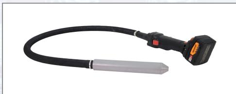
Leistungsstarker Akku-Beton-Innenrüttler für das Entlüften und Verdichten von Frischbeton. Kabelfreies Arbeiten dank bürstenlosem Akkumotor (inkl. Drehzahlregulierung). Leicht, handlich und robust. 100 % kompatibel mit CAS (Cordless Alliance System) Akkupacks (18 V / 5,2 Ah) und Ladegeräte (ASC 55). Akku und Ladegerät nicht im Lieferumfang enthalten!
