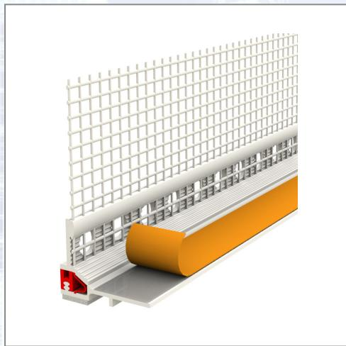
Besonders schmales, 6 mm breites Anputz-Dichtprofil mit Membran, WDVS- Gewebe und Entkoppelung für das WDVS- System. Dreidimensionale Bewegungsaufnahme. Vor der Dämmung verarbeitbar, da Gesamtbreite nur 6 mm. Daher optimal für Renovierungsarbeiten. Schlagregendicht nach DIN EN 1027. Prüfung bei IFT in Rosenheim auf 3-D Aufnahmefähigkeit. Klassifizierung nach ÖNORM B 6400 Klasse III. PE-Dichtband 6x1 mm und 4x3 mm. Verarbeitungstemperatur +5 bis +40 °C.
