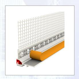
Besonders schmales, 6 mm breites Anputz-Dichtprofil mit Membran, WDVS- Gewebe und Entkoppelung für das WDVS-System. Dreidimensionale Bewegungsaufnahme. Vor der Dämmung verarbeitbar, da Gesamtbreite nur 6 mm. Daher optimal für Renovierungsarbeiten. Schlagregendicht nach DIN 1027. Prüfung bei IFT in Rosenheim Aufnahmefähigkeit. Klassifizierung nach ÖNORM B 6400 Klasse PE-Dichtband 6x1 mm und 4x3 mm. Verarbeitungstemperatur +40 +5
