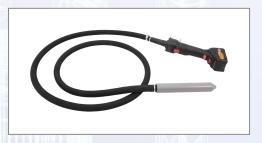
Leistungsstarker Akku-Beton-Innenrüttler für das Entlüften und Verdichten von Frischbeton. Kabelfreies Arbeiten dank bürstenlosem Akkumotor (inkl. Drehzahlregulierung). Leicht, handlich und robust. 100 % kompatibel mit CAS (Cordless Alliance System) Akkupacks (18 V / 5,2 Ah) und Ladegeräte (ASC 55). Akku und Ladegerät nicht im Lieferumfang enthalten! Im Lieferumfang enthalten: Betonrüttlerflasche mit biegsamer
