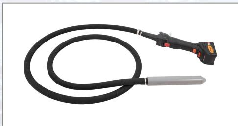
Leistungsstarker Akku-Beton-Innenrüttler für das Entlüften und Verdichten von Frischbeton. Kabelfreies Arbeiten dank bürstenlosem Akkumotor (inkl. Drehzahlregulierung). Leicht, handlich und robust. 100 % kompatibel mit CAS (Cordless Alliance System) Akkupacks (18 V / 5,2 Ah) und Ladegeräte (ASC 55). Akku und Ladegerät nicht im Lieferumfang enthalten! Im Lieferumfang enthalten: Betonrüttlerflasche mit biegsamer
