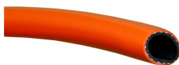
Der LO-TECH ist ein hochwertiger Wasserschlauch für Profis, hergestellt aus einer Mischung von thermoplastischen Polymeren. Betriebsdruck: 12 bar, Platzdruck: 36 bar. Wandstärke: 3 mm (+/- 0,4). Temperaturbeständigkeit: -15/+60 °C. Die spezielle thermoplastische Mischung garantiert extreme Flexibilität, einfache Handhabung, höchste Widerstandsfähigkeit, geringe Verformung unter Druck, Langlebigkeit, UV-Stabilität, hohe Abriebfestigkeit.
