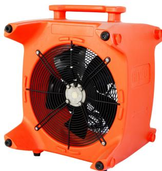
Ideales Arbeitsinstrument für Industrie, Handwerker und Dienstleister. Kompaktventilator mit verschiedenen Aufstellpositionen zur Belüftung von Arbeitsplätzen, Trocknung von Räumen und Wandflächen nach Wasserschäden. Mit eingebautem MID-Energiezähler (geeicht). Technische Daten: - Luftleistung max.: 3687 m<sup>3</sup>/h, - Leistungsaufnahme max.: 0,194 kW, - Pressung max.: 113 Pa, - Abmessungen: (HxBxT) 665 x 520 x 500 mm, - Gewicht: 13,5 kg.
