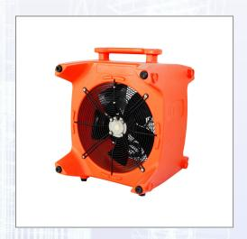
Ideales Arbeitsinstrument für Industrie, Handwerker und Dienstleister. Kompaktventilator mit verschiedenen Aufstellpositionen zur Belüftung von Arbeitsplätzen, Trocknung von Räumen und Wandflächen nach Wasserschäden. Mit eingebautem MID-Energiezähler (geeicht). Technische Daten: - Luftleistung max.: 3687 m³/h, - Leistungsaufnahme max.: 0,194 kW, - Pressung max.: 113 Pa, - Abmessungen: (HxBxT) 665 x 520 x 500 mm, - Gewicht: 13,5 kg.
