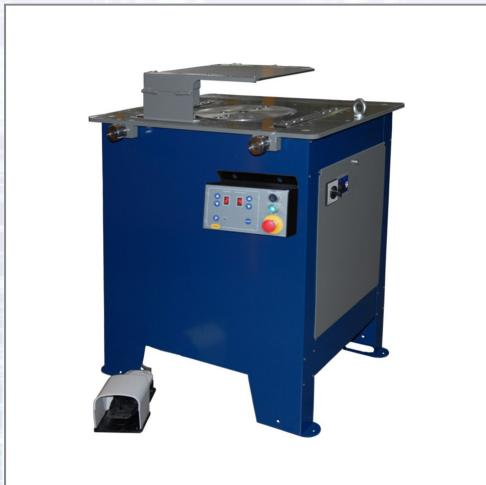
Biegt Rippentorstahl bis 32 mm Durchmesser, Antrieb durch 1,5 kW Elektromotor 400 V, Biegeteller 7 U/min, automatischer Rücklauf des Tellers, Voreinstellung und Auslösung der Biegewinkel durch Kontaktstifte, Bedienung über Fußpedal, Steuerspannung 24 Volt, Notstop-Einrichtung. Mit beweglicher Tafel (9x9), um Biegungen in Sequenz ohne Stiftebewegungen zu
