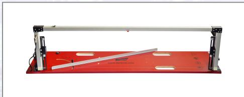
Glühdraht-Schneidgerät für Styropor (Hartschaum), Styrodur (PUR-Schaum) und ähnliche Dämmstoffe. Kein Schneidestaub, keine statisch aufgeladenen Schaumkugelchen. Technische Daten: Schnittlänge: 137 cm, Schnitttiefe: bis 33 cm, Gewicht: 15,1 kg, Schnittvarianten: Parallel-, Schräg-, Stufen-, Falz-,
