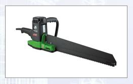
Leistungsstarke Doppelblattsäge für das Schneiden von Hochlochziegel (zB POROTON®), Porenbeton, Holz sowie druckfesten Dämmstoffen. Einfaches Herstellen von Ausklinkungen sowie passgenaues Schneiden der Planziegel. Lange Standzeit und hohe Schnittgeschwindigkeit. Ausstattung: robustes, verwindungssteifes Schwert für präzises Schneiden, zwei gegenläufig arbeitende Sägeblätter für ein rückschlagfreies Sägen, Gebläse-Funktion zum Staubschutz für Getriebe und
