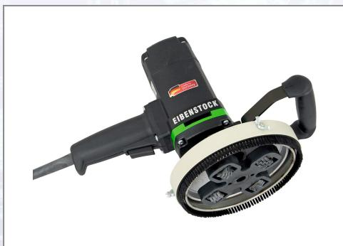
Putz-/Sanierungsfräse mit schwingungsdämpfenden Softbügelgriff für das Abtragen und Entfernen von Putz, Farbe, Fliesenkleber, Beschichtungen sowie Aufrauen von Untergründen. Schleifen von Beton und Schalungsnähten. Elektronik - Sanftanlauf, Drehzahlkonstanthaltung, Drehzahlabsenkung bei Überlast, Temperatur- und Überlastabschaltung. Führungsring höhenverstellbar - Frästiefenbegrenzung. Bürstenkranz - hohe Absaugleistung für staubarmes Arbeiten. Für Diamant-Schleifteller  $d = 150$  mm geeignet.
