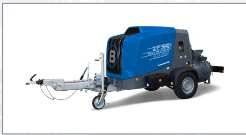
Der EstrichBoy EC 260/45 FLEX DRIVE wird ausschließlich mit Baustellenstrom betrieben und liefert dabei genauso viel Luftleistung wie seine kraftstoffbetriebene Ausführung. Der EC 260/45 ist eine zuverlässige, robuste und effiziente Estrichpumpe mit hoher Förderleistung von erdfeuchten Estrichen wie Zementestrich, Calciumsulfatestrich (Anhydrit), Magnesiaestrich sowie Rüttelboden (konsistenzabhängig).
