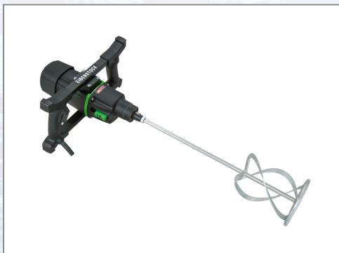
Baustellenkabel. Technische Daten: - Leistungsaufnahme: 1800 W, - Nennspannung: 230 V, - Nenndrehzahl: 1. Gang: 0-250 U/min, 2. Gang: 0-580 U/min, - Leerlaufdrehzahl: 1. Gang: 0-440 U/min, 2. Gang: -970 U/min, - Werkzeugaufnahme: M-14 innen, - max. Rührkorbdurchmesser: 180 mm, - Gewicht: 6,9 kg. Im Lieferumfang enthalten: Mörtelrührer MG 160 d= 160 mm.
