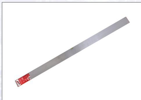
Alu-Rohrprofil mit Mittelsteg und verstärkter Seitenwand 4 mm, mit 1 Waagrechtlibelle. Dimension 83x18 mm, 830 g/lfm, entgratetes Profil, daher keinerlei Verletzungsgefahr, bruchfeste Acrylglas-Blocklibelle (mit Leuchtplättchen unterlegt) und stoßgedämpfte Endkappen. Maximale Messtoleranz in Standardposition 0,5 mm/m (0,029 °).
