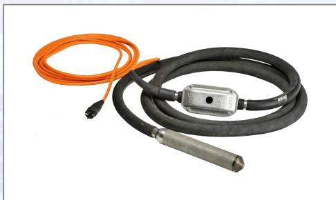
Der LATI U ist eine Kombination aus Innenrüttler und Frequenzumformer. Der Umrichter ist im Schaltergehäuse integriert und somit ist der direkte Anschluss an 230 V / 50 Hz möglich. Große Betriebssicherheit, außerordentliche Verdichtungsleistung und robuste Konstruktion zeichnen ihn aus. LATI U arbeiten mit 12.000 U/min. Ausgestattet mit Hochfrequenz-Vibriernadel mit 5 m Schutzschlauch, Schalter mit integriertem elektronischen FU, 10 m Kabel und Schukostecker.
