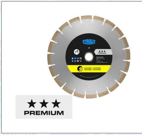
Diamant-Nassschnittsägeblätter für Tischsägen sind universell einsetzbar für Waschbeton, Betonstein, Kalkstein hart, Ziegel weich etc. Bei allen Tischsägeblättern sind Reduzierringe von 35 auf 30 mm bzw. 25,4 mm beigelegt. Ab Durchmesser 625 mm werden Reduzierringe von 60 auf 55 mm mitgeliefert. Geräuschedämpftes Stammbrett in Sandwichbauweise.
