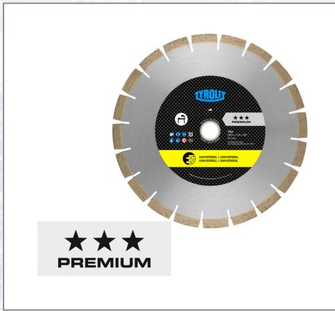
Diamant-Nassschnittsägeblätter für Tischsägen sind universell einsetzbar für Waschbeton, Betonstein, Kalkstein hart, Ziegel weich etc. Den Tischsägeblättern bis Durchmesser 550 mm sind Reduzierringe von 35 auf 30 mm bzw. 25,4 mm beigelegt. Ab Durchmesser 625 mm werden Reduzierringe von 60 auf 55 mm mitgeliefert.
