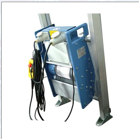
Schrägaufzug Comfort mit einer Nutzlast bis 250 kg. - Hubgeschwindigkeit 30 m/min (1-stufig), - Motor 1,3 kW / 230 V / 50 Hz. Grundeinheit bestehend aus: - Elektrowinde (230 V / 50 Hz) mit 43 m Seil (d= 6 mm), - 21 m Endschalterkabel, - Steuerung (24 V) mit Not-Aus und 5 m Leitung, - Standardschlitten mit Seilbruchsicherung, - Kopfteil mit Schnellverschluss-Umlenkrolle, - 2 m Fußteil, - Steuerung und Endschalter steckbar.
