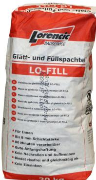
Gipsspachtelmasse zum Ausgleichen größerer Wand- oder Deckenflächen und Unebenheiten bis zu einer Schichtstärke von 8 mm sowie zum Ausfüllen von Stößen zwischen Gipskartonplatten und Ausbessern von bis zu 8 mm tiefen Ritzen, Schrammen und Dellen sowie zum Glätten von Innenwandflächen. - ca. 80 Minuten verarbeitungsfähig, - Trocknung/weiterverarbeitbar bei + 20 °C und rel. Luftfeuchte 65 %: mind. nach 1 Tag (bei 1 mm Dicke), - hohe Dampfdurchlässigkeit.
