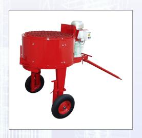
Eignet sich besonders zum Mischen von steifplastischen und erdfeuchten Estrichen. Der EM 120 mit Kettenantrieb ist mit der Schiebetruhe ganz unterfahrbar. Technische Daten: - Trommelinhalt: 180 I, - Füllmenge: 120 I, - Getriebemotor: 400 V / 4 kW, - Drehzahl: 40 U/min, - Breite: 1080 mm, - Höhe: 1170 mm, - Länge der Deichsel: 2400 mm, - Gewicht: 200 kg.
