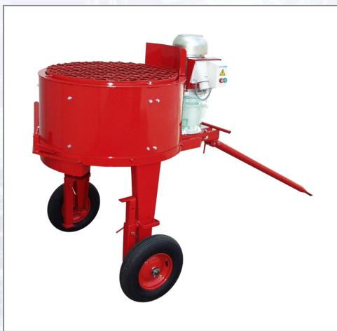
Eignet sich besonders zum Mischen von steifplastischen und erdfeuchten Estrichen. Der EM 120 mit Kettenantrieb ist mit der Schiebetruhe ganz unterfahrbar. Technische Daten: - Trommellinhalt: 180 l, - Füllmenge: 120 l, - Getriebemotor: 400 V / 4 kW, - Drehzahl: 40 U/min, - Breite: 1080 mm, - Höhe: 1170 mm, - Länge der Deichsel: 2400 mm, - Gewicht: 200 kg.
