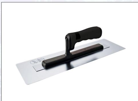
Die PAJAQUICK-Spachtelkelle entspricht den neuesten Anforderungen des Handwerks an optimal gespachtelte Oberflächen im Bereich Q3 und Q4. Das Blatt aus 0,5 mm Spezial-Edelstahl mit abgerundeten Ecken ermöglicht eine nahezu gratlose Verspachtelung von Wand- und Deckenflächen. Gleichzeitig ist die Gewichtsreduzierung durch die neuartige Kunststoffstütze eine enorme Erleichterung für den Anwender.
