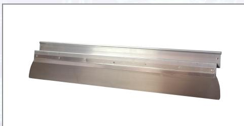
Aluminiumhalter für präzises, zeitsparendes Arbeiten inkl. 1 Blatt aus gehärtetem, poliertem, rostfreiem Federbandstahl. Für exaktes, scharfkantiges Nachziehen und gleichzeitiges Glätten bis Qualitätsstufe Q3. Ideal zum Glätten von Gips- und Armierputzen sowie zur Gewebeeinbettung und Verspachtelung von Gipskartonfugen.
