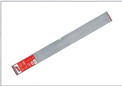
Alu-Rohrprofil mit Mittelsteg, mit 1 Waagrechtlibelle. Dimensionen 100x18 mm, 860 g/lfm. Entgratetes Profil, daher keinerlei Verletzungsgefahr, bruchfeste Acrylglas-Blocklibellen und stoßgedämpfte Endkappen. Maximale Messtoleranz in Standardposition 0,5 mm/m (0,029 ‰).
